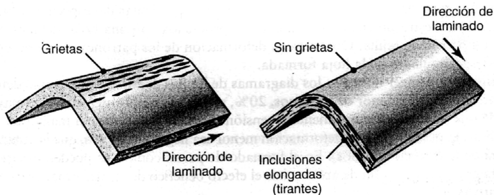
Figura 1.36 Relación de las inclusiones elongadas (tirantes) y la dirección de laminado xxvii .
