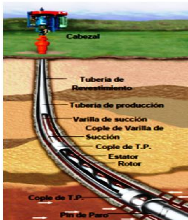
Figura 3.5 Componentes de la bomba de cavidades progresivas
