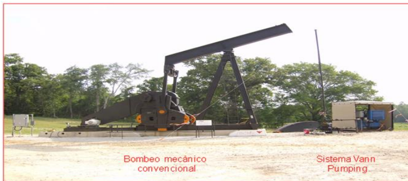
Figura 3.10 Esquema comparativo de un sistema mecánico convencional y un sistema vann pumping
