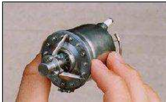
Fig. 4.6 Microturbina diseñada por la agencia de proyectos de investigación avanzada para la defensa (DARPA)
