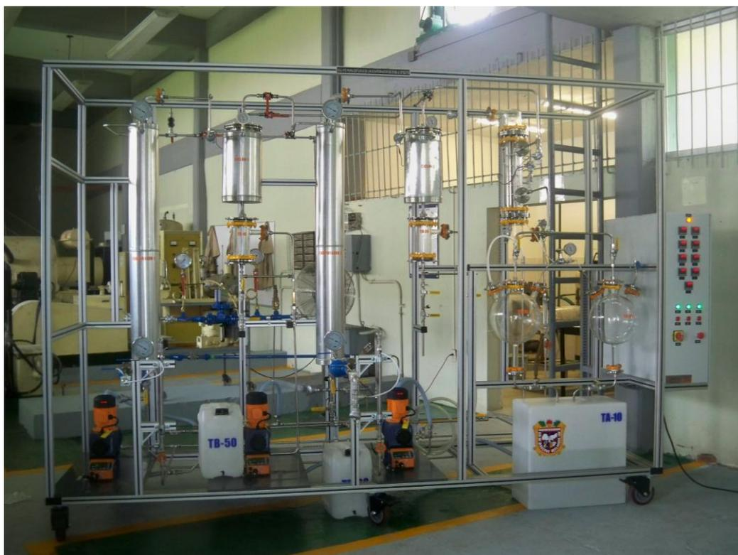
*Figura 2.7. Equipo para estudio de un evaporador de doble efecto. Archivo general de Generatoris.*
