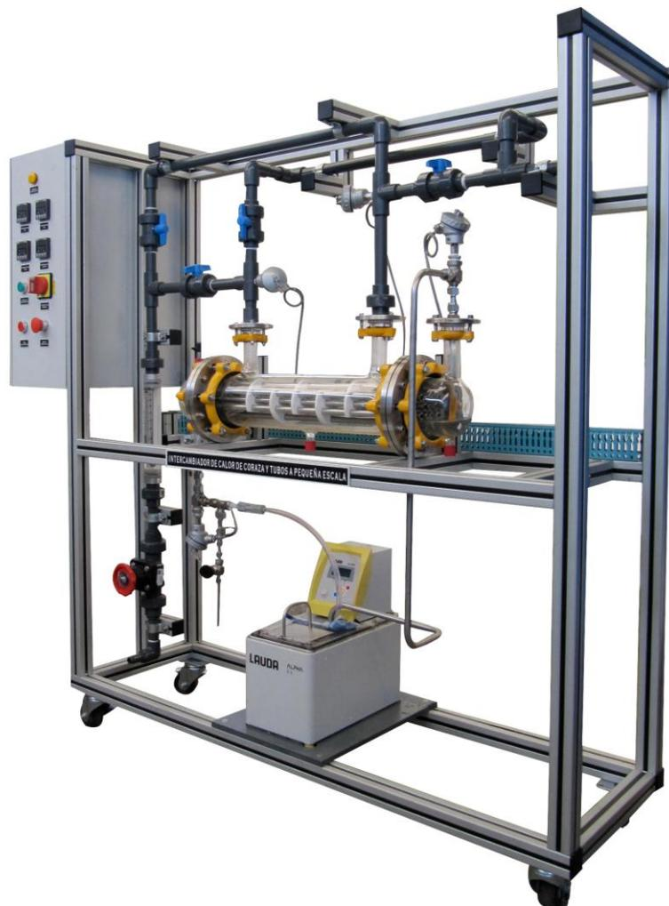
Figura 2.5. Intercambiador de calor de coraza y tubos a pequeña escala. Archivo general de Generatoris.
