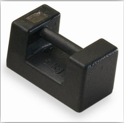
Figura 2-Patrón de masa de 5 [kg]. En este tipo de pesas la masa varía desde 5 [kg] hasta 25 [kg].
