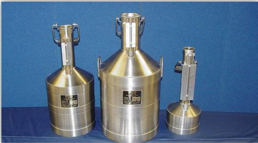
Figura 2-Medidas volumétricas de 5, 20 y 60 [l]
