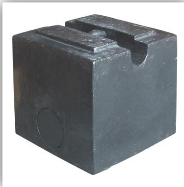
Figura 3-Patron de masa para básculas de alto alcance. 1000 [kg]
