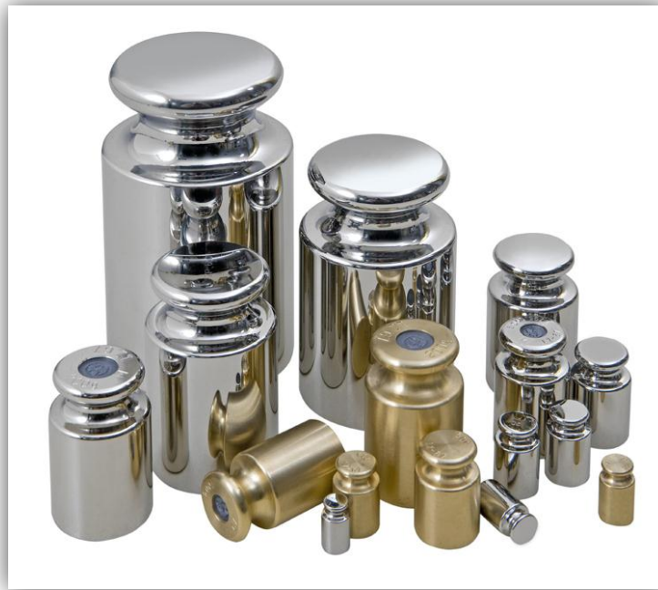
Figura 1-Patrones de masa desde 10 [g] hasta 10 [kg] utilizados para básculas de bajo y mediano alcance.
