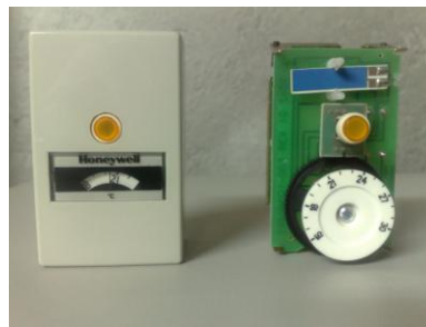
Fig. 1.3. Elemento sensor de temperatura
