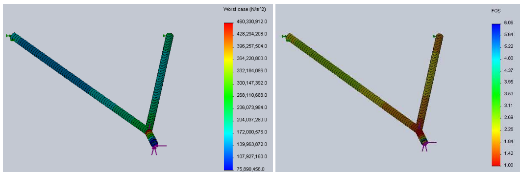
Imagen 6.50 Izquierda análisis de esfuerzos, derecha factor de seguridad
