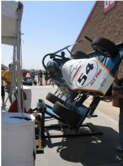
Imagen 3.1 Prueba de inclinación a 60°
