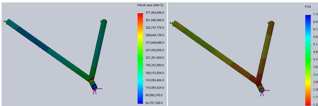
Imagen 6.52 Izquierda análisis de esfuerzos, derecha factor de seguridad
