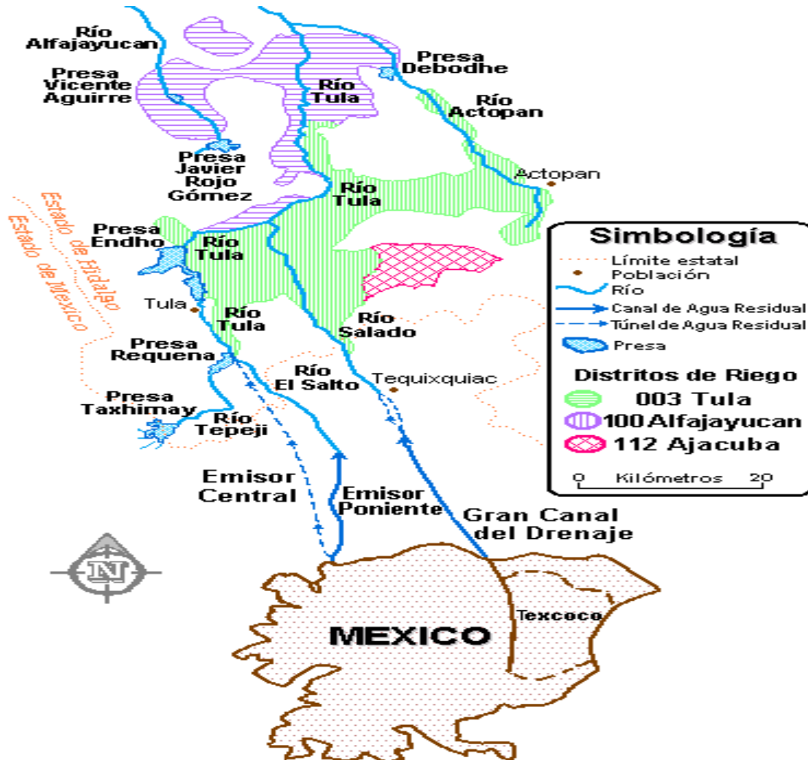
Figura 1.1. SISTEMA DE DRENAJE DEL VALLE DE MÉXICO
