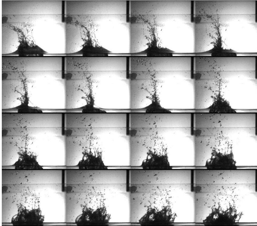
Figura 28. Pln zamiento después de que cae el modelo a escala al agua.
