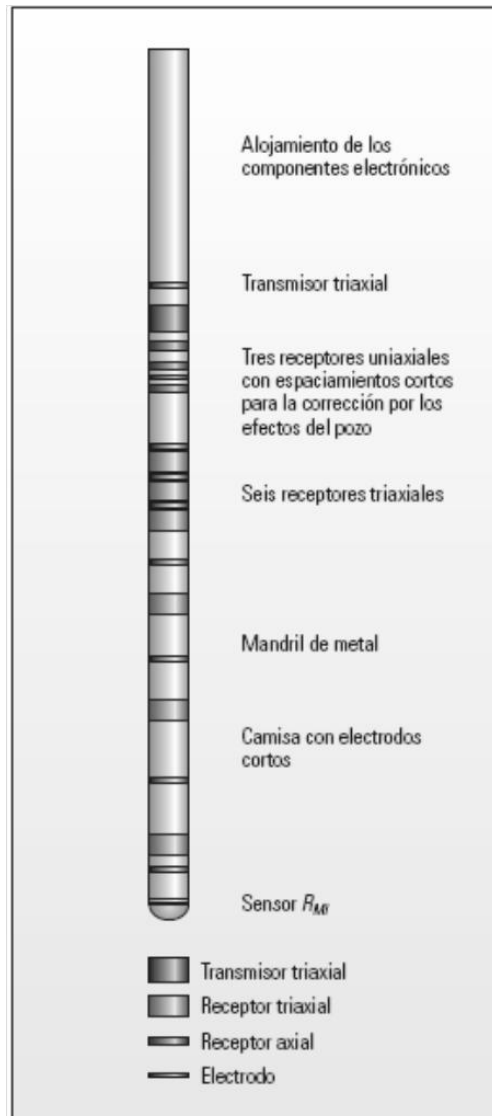
Fig. II.26. Esquema de una sonda de inducción triaxial 14 .
