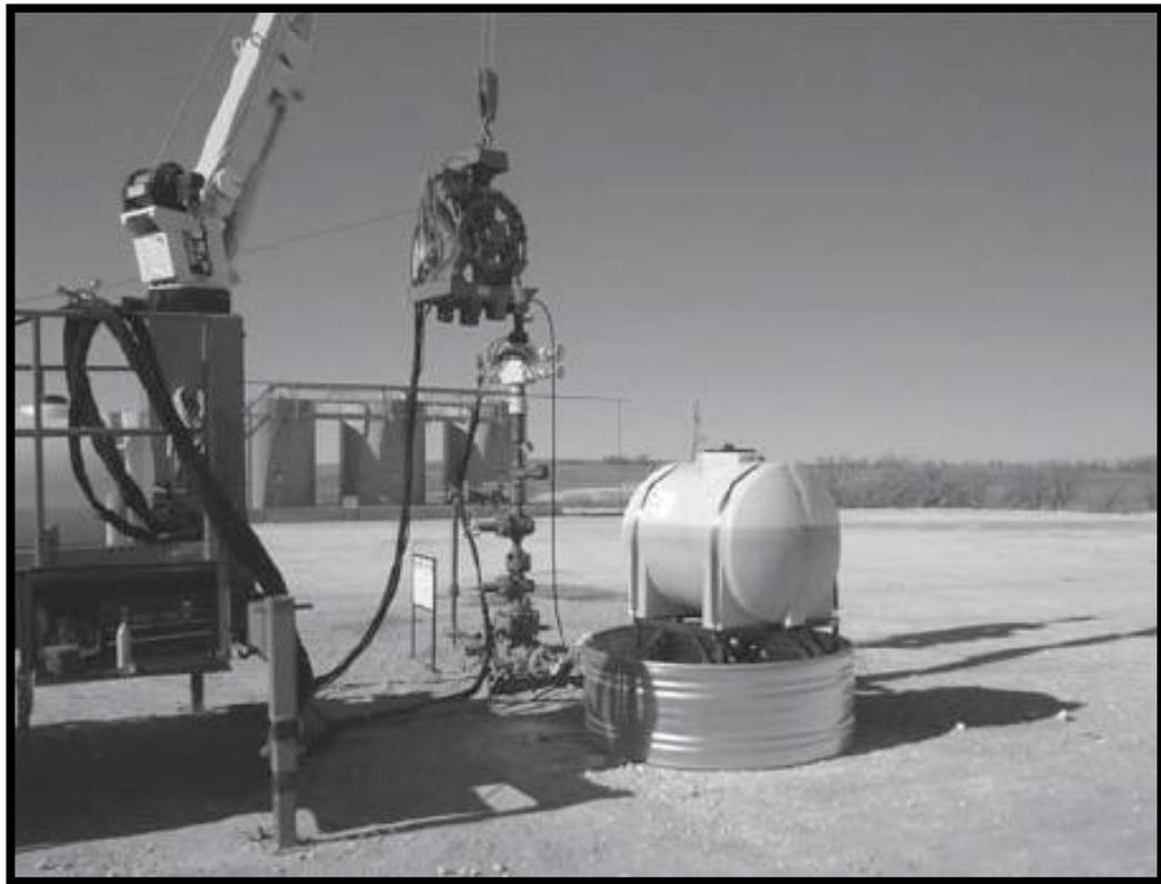
*Figura 3.33 Sistema de instalación de una tubería capilar.*
