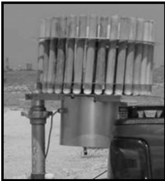
Figura 3.30 Pozo con lanzador de barras espumantes.
