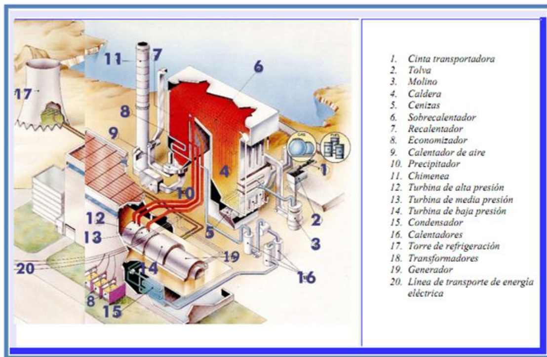
Fig. 4. 5 Partes Internas de una Termoeléctrica
