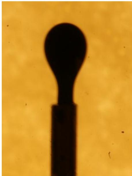
**Figura 1.5.** Gota de aceite en agua de mar + surfactante para la aplicación del método de la gota pendiente para la determinación de la TIF
