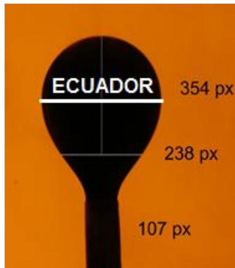
Figura 1.8 muestra la forma experimental de una gota con ecuador, ideal para tomar la medición de la tensión mediante el método de la gota pendiente
