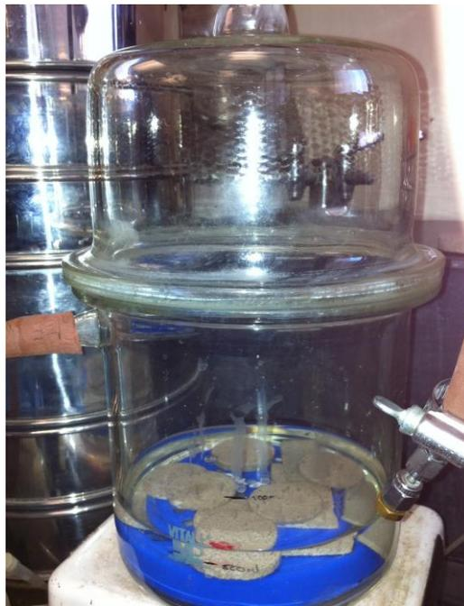
**Figura 2.2.** Saturación de roca caliza con agua de formación empleando una bomba de vacío.
