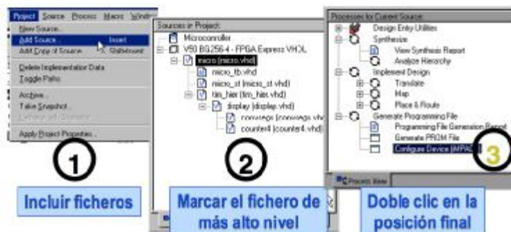
Figura 2.3.8 Proceso simplificado para el desarrollo de un diseño en Xilinx ISE.
