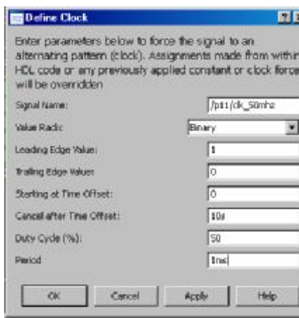
Figura 3.11.7 Reloj Clk_50mhz Simulación
