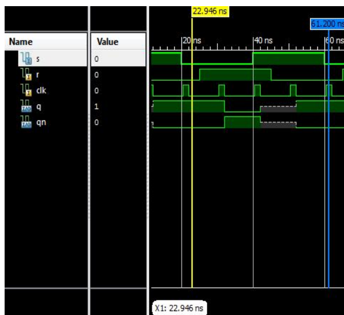
Figura 3.9.9-A Q = ultima Q y Qn = ultima Qn
