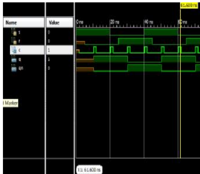
Figura 3.9.5-A Q = ultima Q y Qn = ultima Qn
