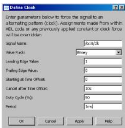
Figura 3.10.9 Reloj CLK Simulación
