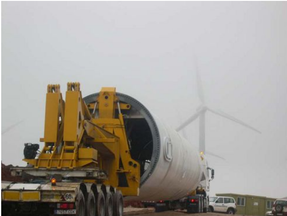
Figura 3.18 Transporte de tramos de torre de aerogeneradores. Fuente. IBERDROLA.
