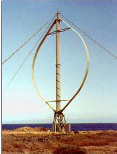
Figura 1.23. Aerogenerador de eje Vertical.
