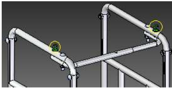
Fig.5.12 Posiciones de los seguros de plegado.
