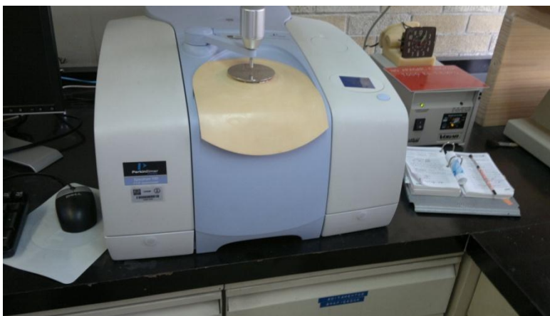
Fig 3.6 Equipo FTIR, laboratorio de Instituto de Ciencias Nucleares
