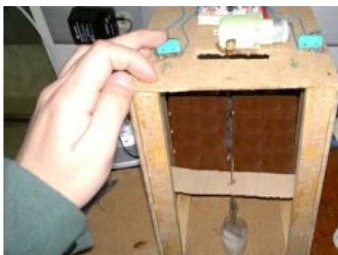
Fig. 3.2 Dispositivo experimental de la técnica de deposición de recubrimiento sol-gel por inmersión “Dip-Coating”
