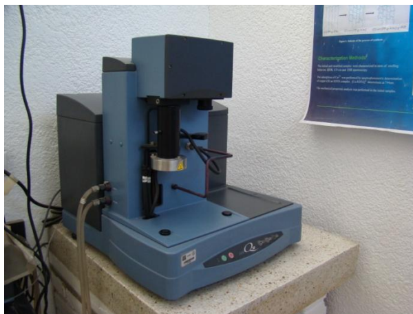
Fig. 3.5 Dispositivo TGA, laboratorio del Instituto de Ciencias Nucleares
