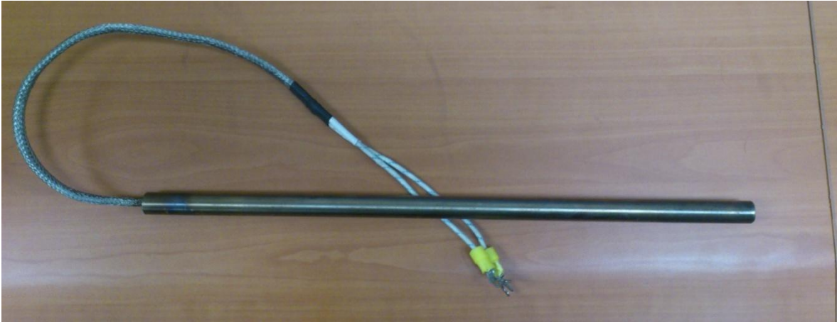
Figura 3.7 Resistencia de cartucho 1800 [W] a 220 [V].
