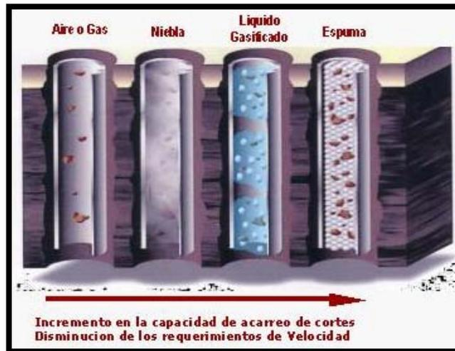
Figura 2.2- Diferentes fluidos compresibles usados en la PBB.
