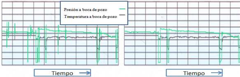
Figura 1.8. Limpieza y reducción de datos ruidosos, el registro de la izquierda muestra datos de alta frecuencia con ruido. El de la derecha muestra el mismo registro, libre de ruido y listo para ser empleado con los programas de modelado 12 .
