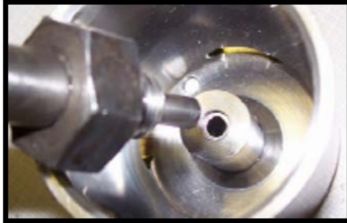
Figura 2.9 Forma de retirar la pieza de hule del cilindro exterior.
