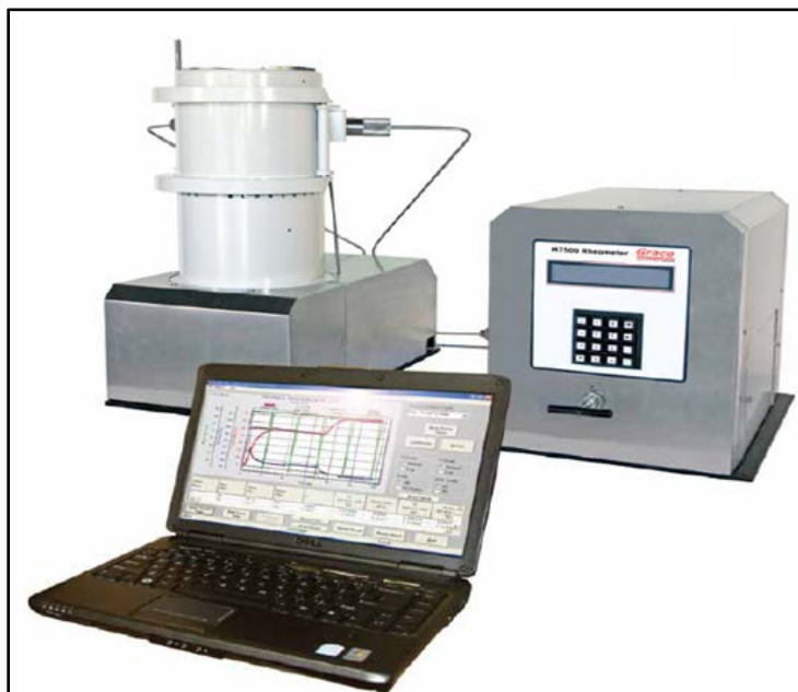
Figura 2.2 Equipo de reología utilizado.
