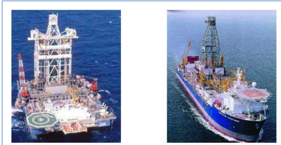
Figura 3.19 Plataforma Semisumergible y Barco de Perforación especializado.
