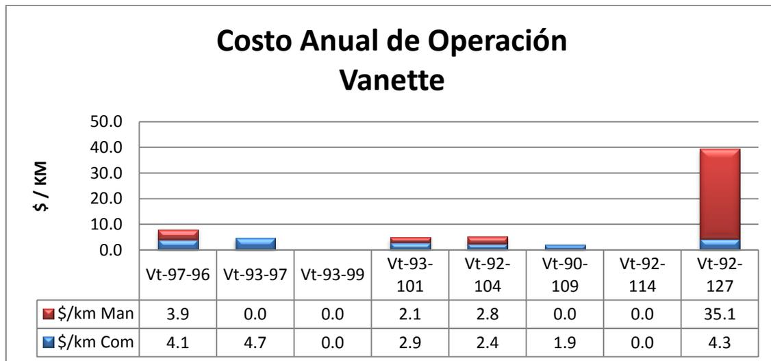
En la gráfica se muestra la relación de costos en mantenimiento y combustible de los vehículos Vanette, se aprecia que el vehículo Vt-92-127 presenta un gasto mayor en mantenimiento en comparación con el combustible.
