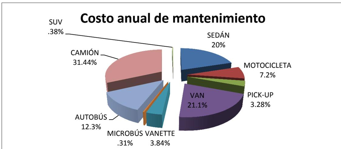
Los costos de operación de la flota vehicular corresponden a los costos de combustible y costos de mantenimiento. Las siguientes gráficas muestran los costos de operación por tipo de vehículo en función de los kilómetros recorridos por unidad. Es importante observar que el índice de costo de mantenimiento sea menor al índice de costo de combustible. En caso contrario, el vehículo no es rentable dado que cuesta más mantenerlo, que el uso del mismo.
