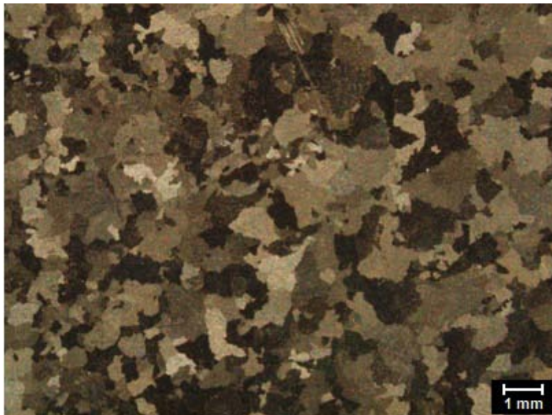
Fig. 4.11 Muestra de homogeneización de la aleación Al-4.5Mg-0.2Sc en microscopio estereográfico (16X)
