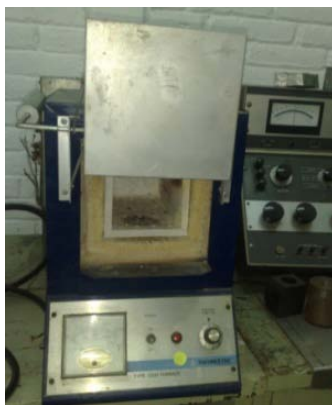
Fig. 3.6 Horno utilizado para tratamientos térmico (IIM-UNAM)
