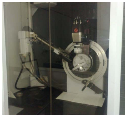
Fig. 3.18 Equipo de difracción de rayos X Bruker D8 (IIM-UNAM).
