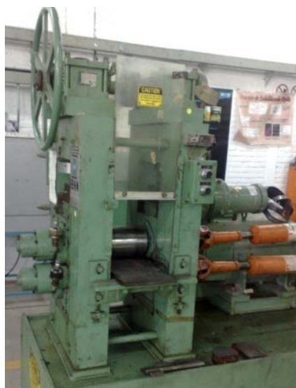
Fig. 3.8 Equipo de Laminación Chicago Gear D.O. James (IIM-UNAM)
