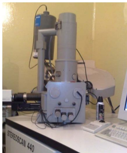
Fig. 3.15 Microscopio electrónico de barrido Stereoscan 440 (IIM-UNAM)
