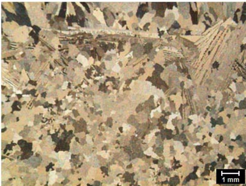
Fig. 4.7 Muestra de fundición de la aleación Al-4.5Mg-0.2Sc en microscopio estereográfico (16X)
