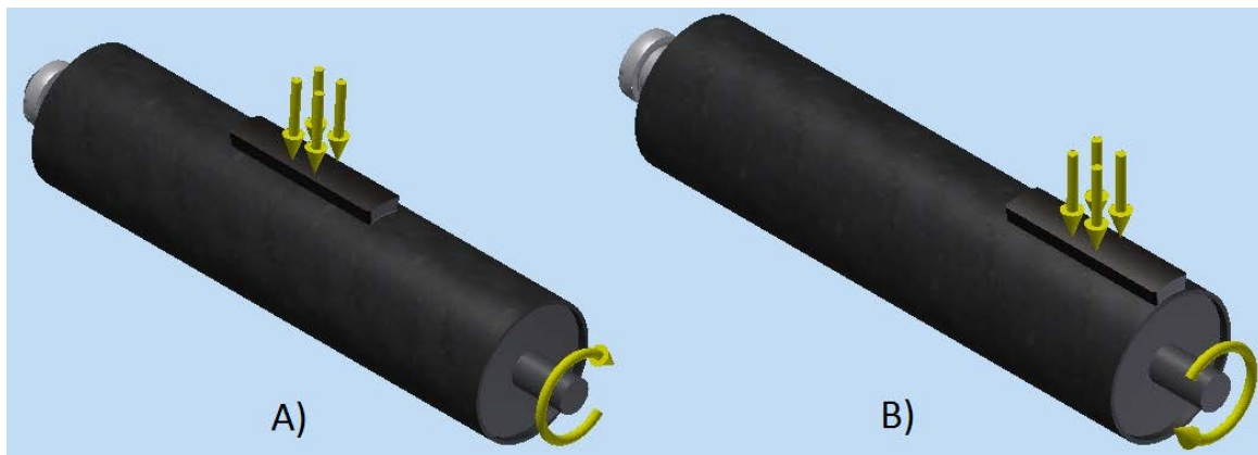
Figura 16 Condiciones críticas bajo las que se realizó el análisis por elementos finitos.
