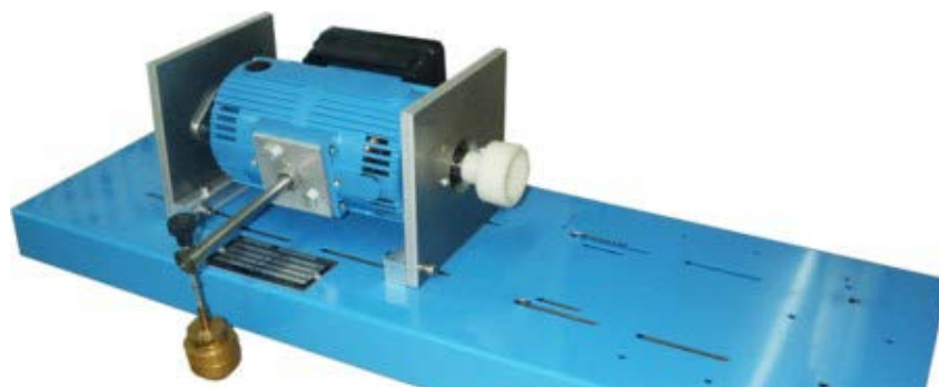
Figura 7 Dinamofreno empleado como freno en un dinamómetro de banco
