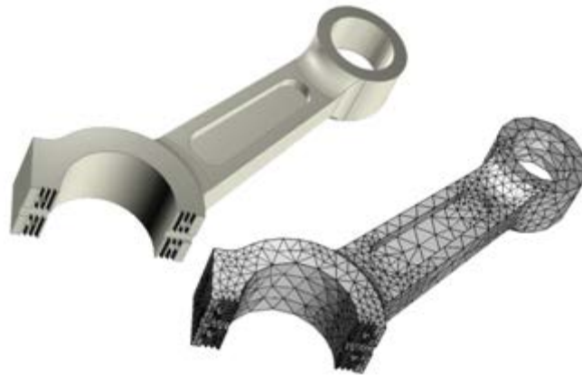
Figura 8 Se muestra pieza original y pieza dividida mediante líneas y superficies imaginarias formando los "elementos" reproducción realizada con fines didácticos fuentes: www.comsol.com
