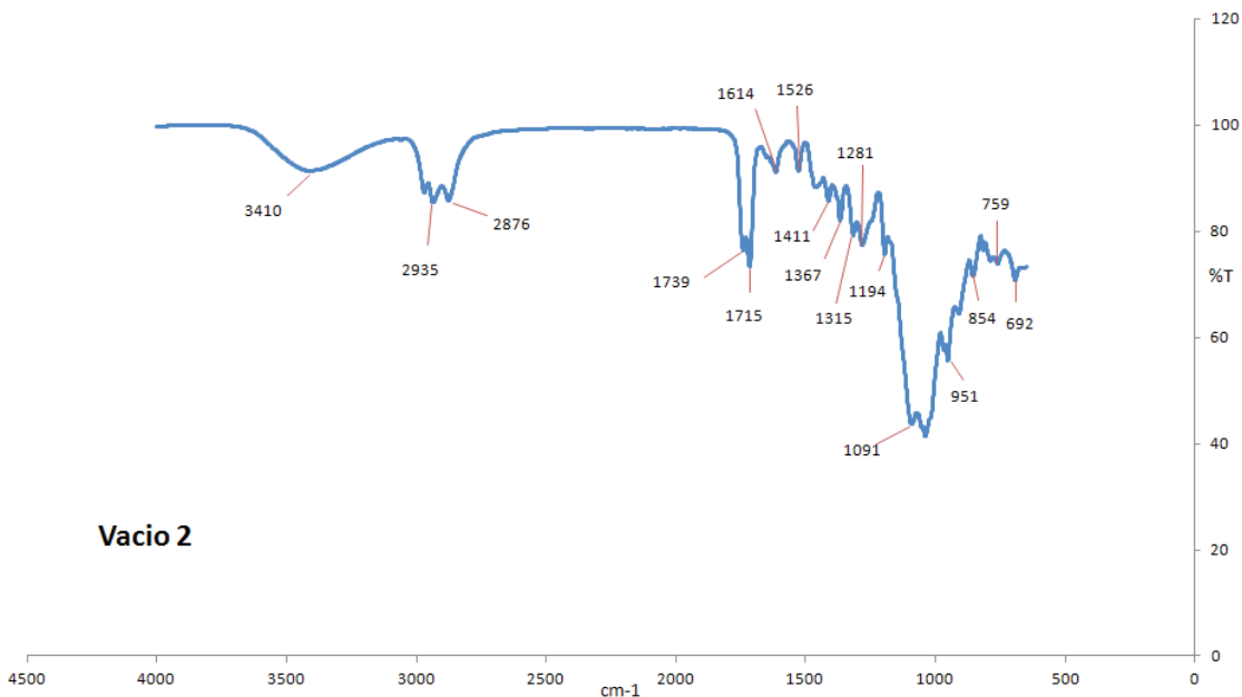
Figura 3.2.4. Espectro de Infrarrojo del Sol-Gel dopado con Zirconia obtenida evaporando solventes de TPO a 250°C durante 4h 45 min, posteriormente, sin vacío calentamiento a 300°C durante 15min, 350°C por 15 min y 400°C durante 30 min.
