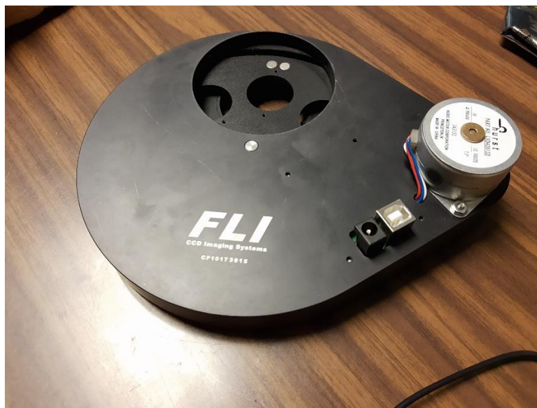
Figura 2.6 Rueda de filtros FLI.
