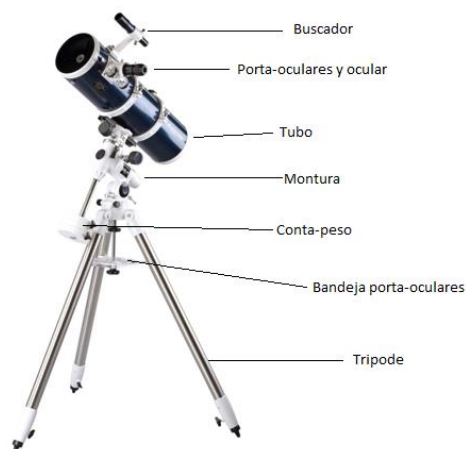
Figura 1.7 Elementos que integran un telescopio [10].
