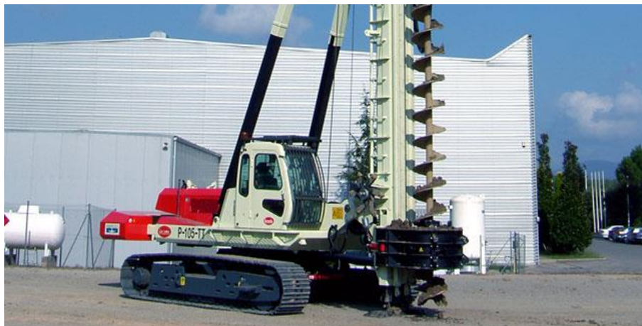
Fig. 40 " Perforadora de hélice continua (LLamada-, 2012) "
