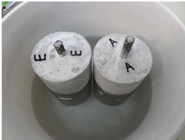
Figura 3.5. Probeta “A” (relación a/c =0.59) y “E” (relación a/c =0.63) en solución salina, para simulación de corrosión por cloruros.
