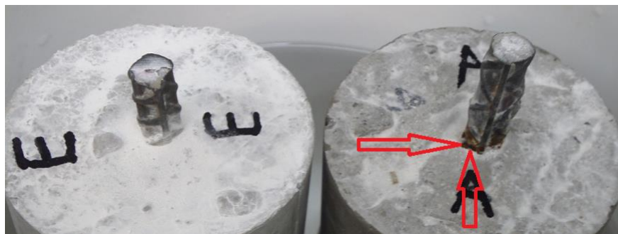
Figura 4.3. Primeros indicios de corrosión en las probetas sumergidas en solución salina, expuestas en el día 3.
