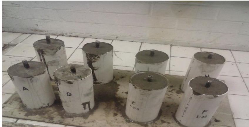
Figura 3.2. Probetas después de ser coladas.
