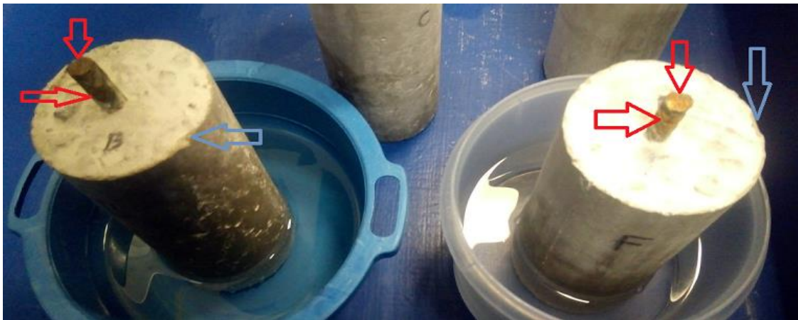
Figura 4.11. Deterioro de probetas en solución salina y gases, durante el ciclo número 40.
