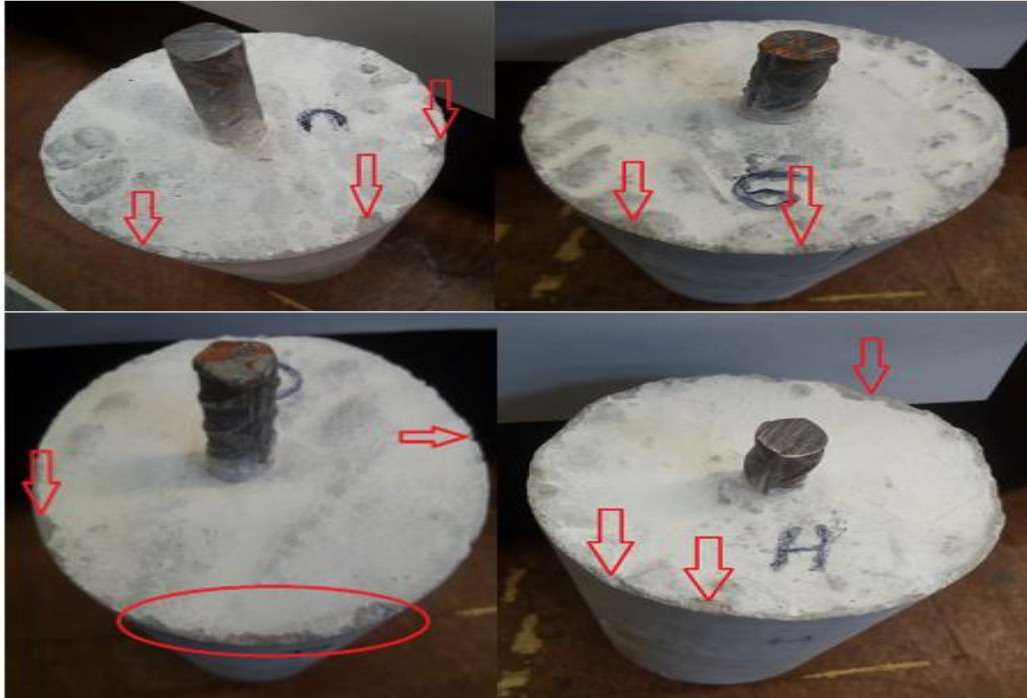
Figura 4.12 B. Deterioro de las probetas sometidas a gases en el ciclo 133, las flechas y óvalos muestran la pérdida de material (concreto).
