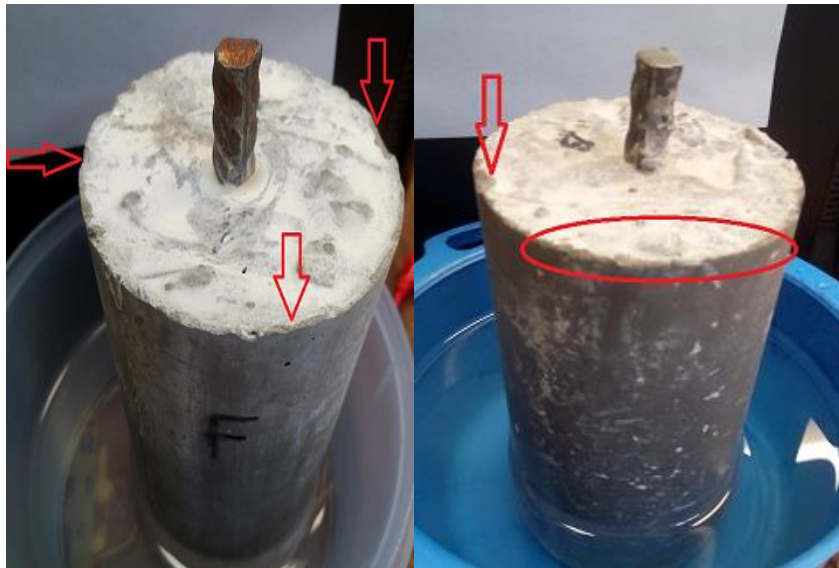
Figura 4.12. Deterioro de las probetas en el ciclo número 133 en solución salina y gases, las flechas y los óvalos muestran el desprendimiento de concreto.
