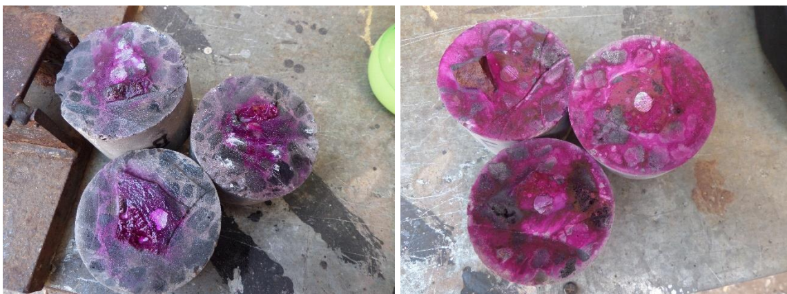
Figura 4.7. Cambio de coloración en las secciones de las probetas “B” (izquierda) y “F” (derecha), inmersas en solución salina.
