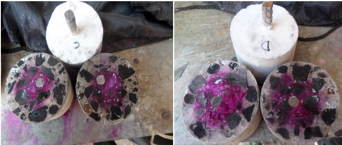
Figura 4.8. Cambio de coloración en las secciones de las probetas con relación a/c =0.59.
