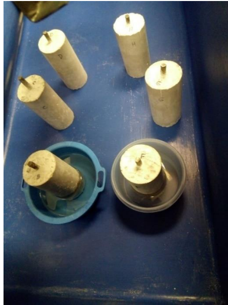
Figura 3.6. Acomodo de probetas en la cámara de en sayos acelerados
