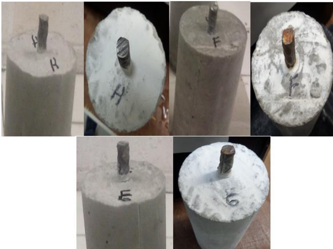
Figura 4.15. Comparación del previo y después de los ensayos en las probetas con relación a/c =0.63.
