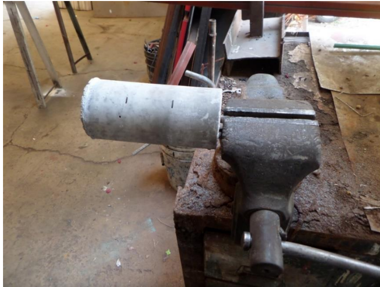
Figura 3.10. Muestra de cómo se sujetó cada probeta para realizar los cortes.
