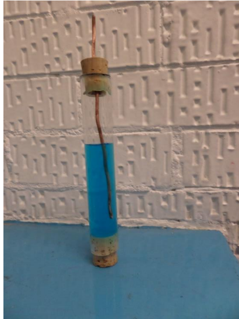
Figura 3.4. Electrodo de referencia Cobre-Sulfato de Cobre (Cu/CuSO 4 )
