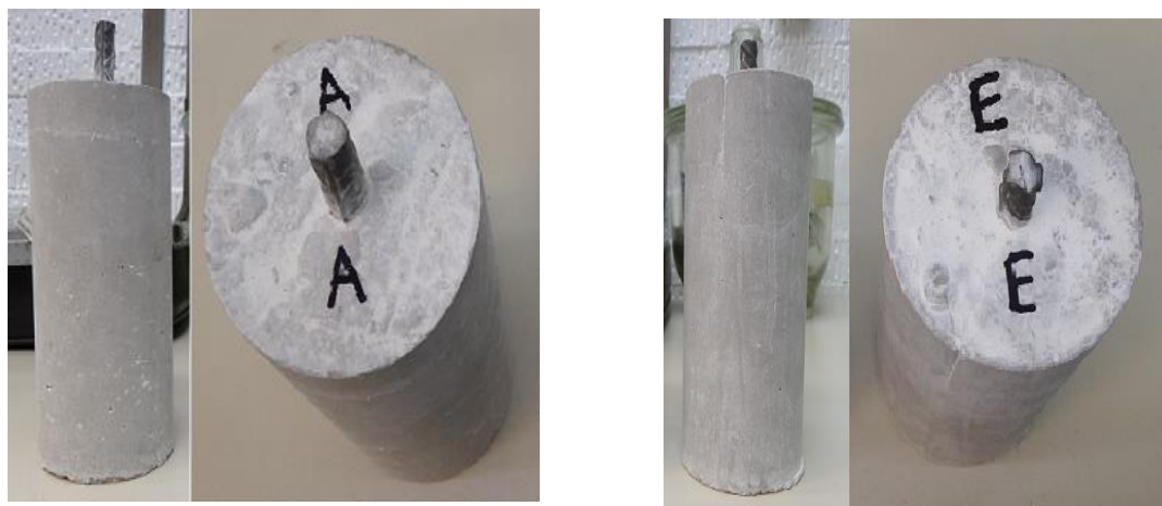
Figura 4.1. Probetas antes de ser parcialmente sumergidas en solución salina. Probeta “A” relación a/c = 0.59, probeta “E” relación a/c= 0.63.
