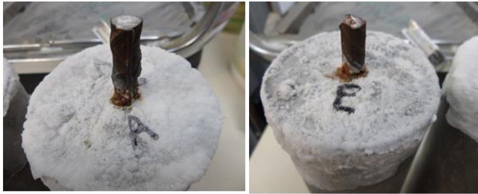
Figura 4.2. Acumulación de eflorescencias en las probetas al finalizar los ensayos de ion cloruro.
