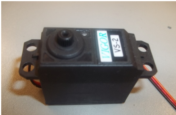
Figura 4.4 Servomotor para mover bases y brazos
