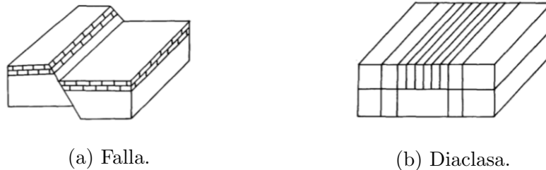
Figura 2.1: Representación esquemática de los tipos de fractura (van Golf-Racht, 1982).
