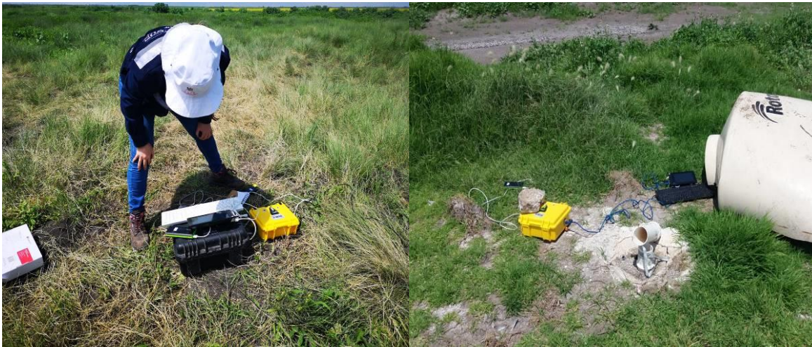
Figura 4. Equipo y ejecución de la prueba de vibración ambiental.
