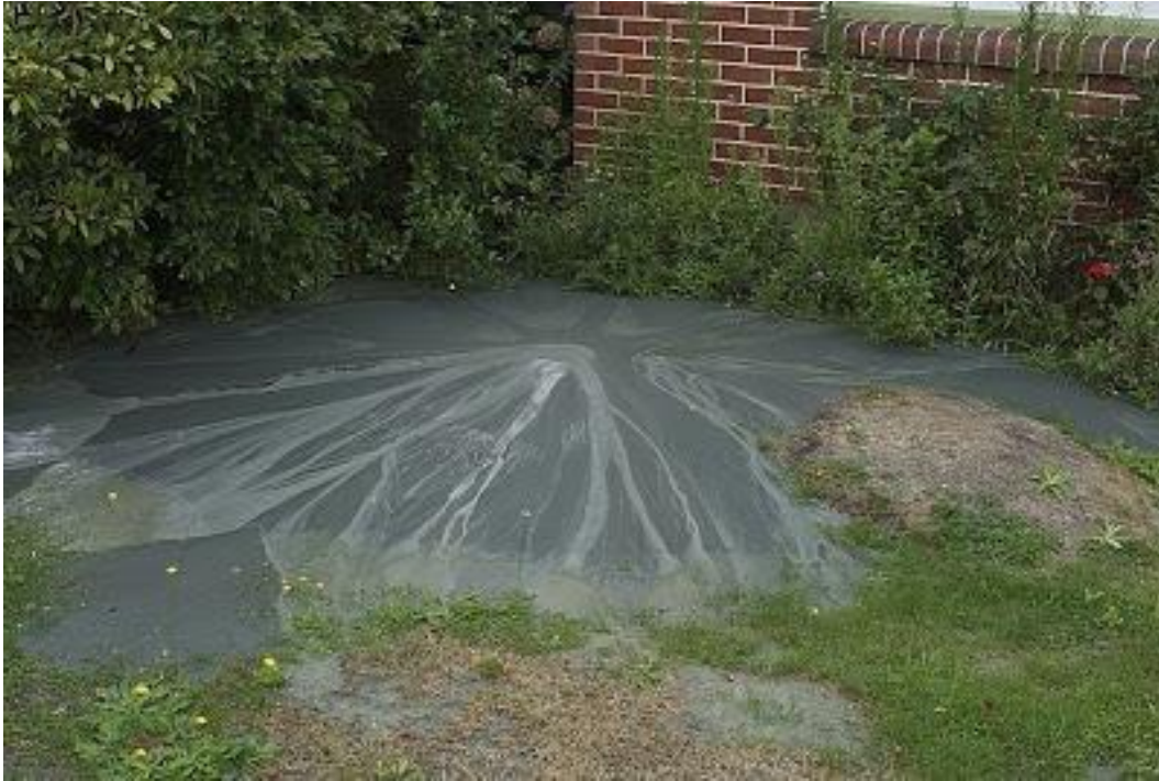
Figura 1.17. Formación de volcanes de arena.
