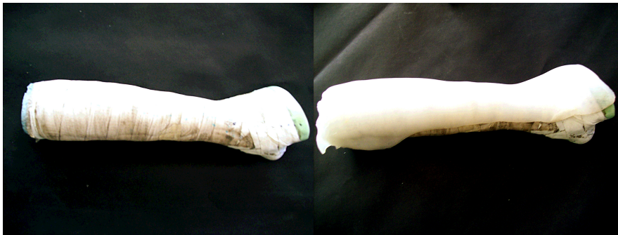
Figura 5.7: Duplicado del antebrazo y palma de la mano en yeso (izq); Poli-propileno termoformado sobre el duplicado (der).
