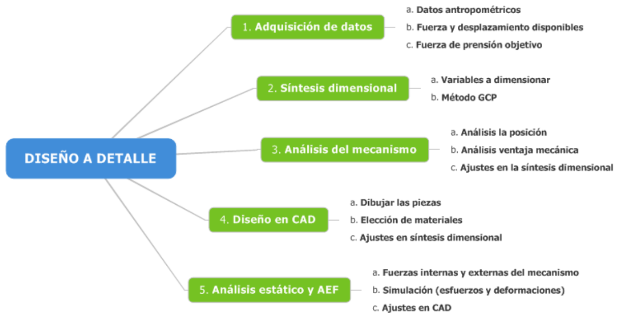
Figura 4.1: Proceso de diseño para la ortoprótesis
