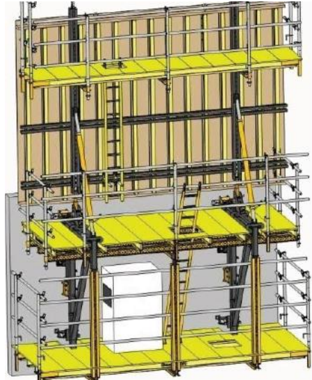
Fig. 51. Construcción de la segunda tongada. Recuperado de: Ulma Construction.
