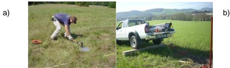
Figura II.12 a) Martillo y placa metálica para favorecer propagación de ondas compresionales, b) viga de cortante para favorecer propagación de ondas de cortante (Parra, 2011).
