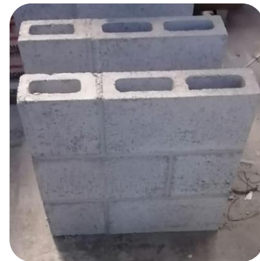
Figura 3.2 Probetas para ensaye a compresión y compresión diagonal de mampostería
