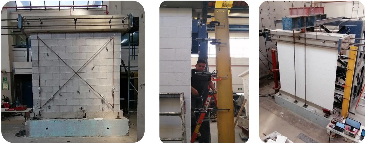
Figura 3.8 Instrumentación de los especímenes, espécimen MBRI-8
