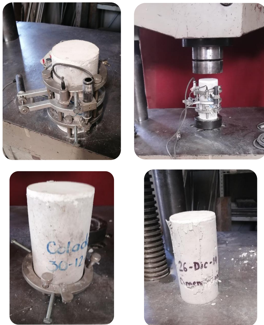
Figura A.7 Ensayo de cilindros de concreto
