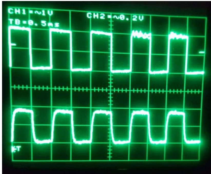
Figura 5.20 Forma de onda cuadrada. Señal superior es la transmitida, señal inferior es la recibida
