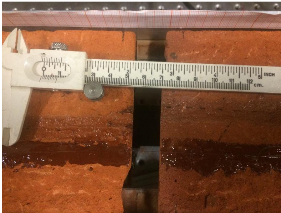
Figura A.1 Ensayo de fibra óptica con recubrimiento de poliamida y pegamento acrílico
