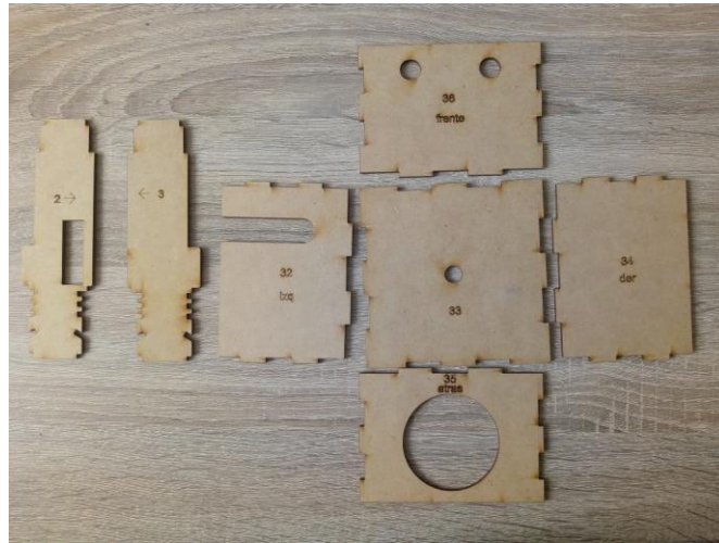
Figura 23: Piezas en MDF de piernas y cabeza del robot
