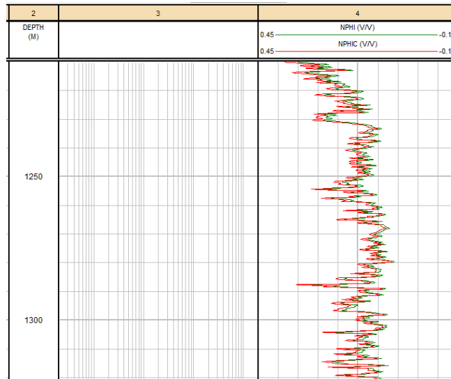
Figura III-8. Curvas medida y corregida de porosidad-neutrón en el pozo del campo Acuatempa.
