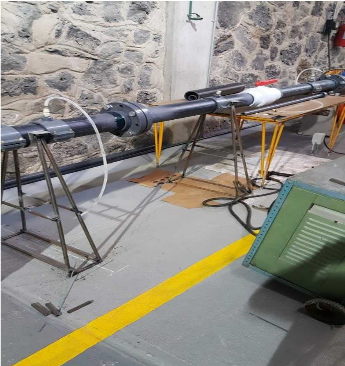
Fig. 6 Instalación y distribución de las tomas y válvulas de control de flujo en el Simulador
