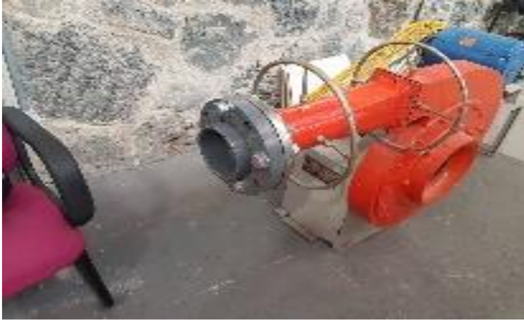
Fig.2b Vista frontal de acoplamiento y anillos de cobre (toma de muestras de la presión del fluido).
