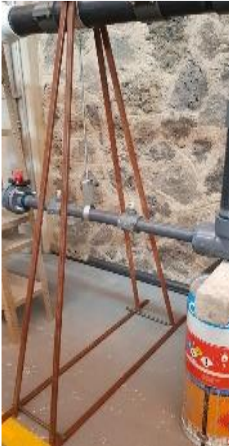
Fig.7d. Diseño del soporte mayor del Simulador trabaja a tension y compresion para amortiguar mayor vibracion.
