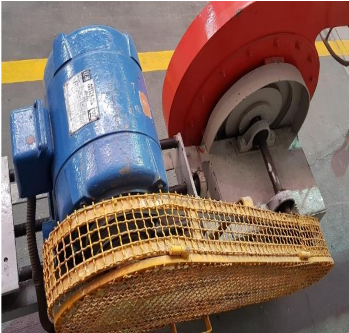
Fig. 11 Motor Eléctrico (azul) con sistema de transmisión de poleas 3 velocidades
