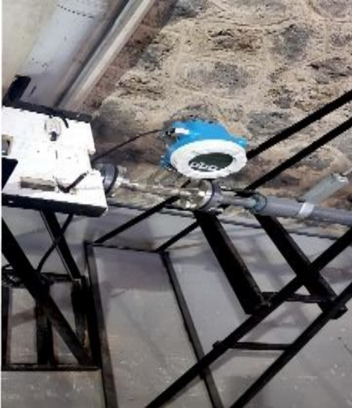
Fig. 8b Analizador de flujo Vortex se utilizará para observar el caudal que circula por este con las diferentes configuraciones en la tubería del Simulador.
