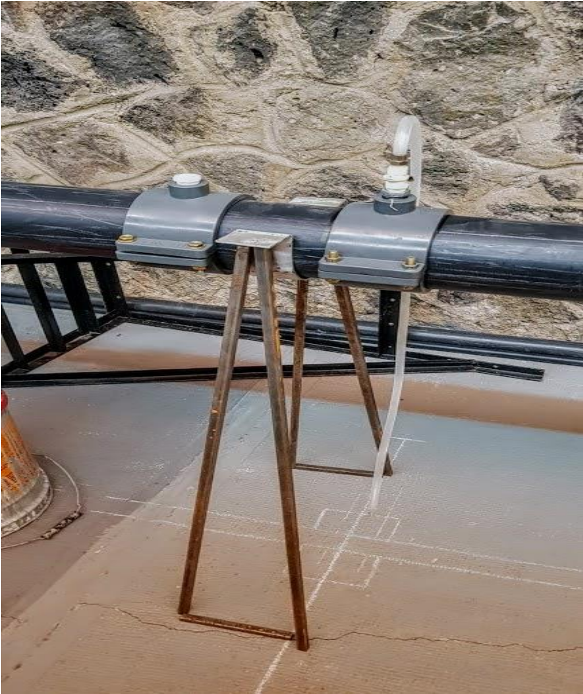
Fig. 4 Primer soporte diseñado para ensamblar y soportar peso del cuerpo de Simulador.
