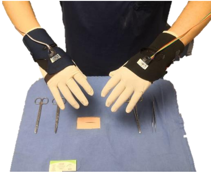
Figura 48 Muestra de cómo deben de estar montados los sensores sobre la parte posterior del brazo, al igual que los cables siempre deberán de tener la dirección hacia los brazos.
