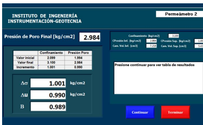
Figura 3.6. Medición del parámetro B de Skempton.
