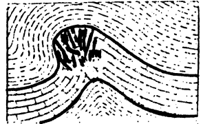
24 - ZONA FRACTURADA (H)
