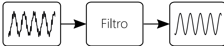
Figura 2.4: Un filtro es capaz de atenuar o eliminar componentes no deseadas en una señal.
