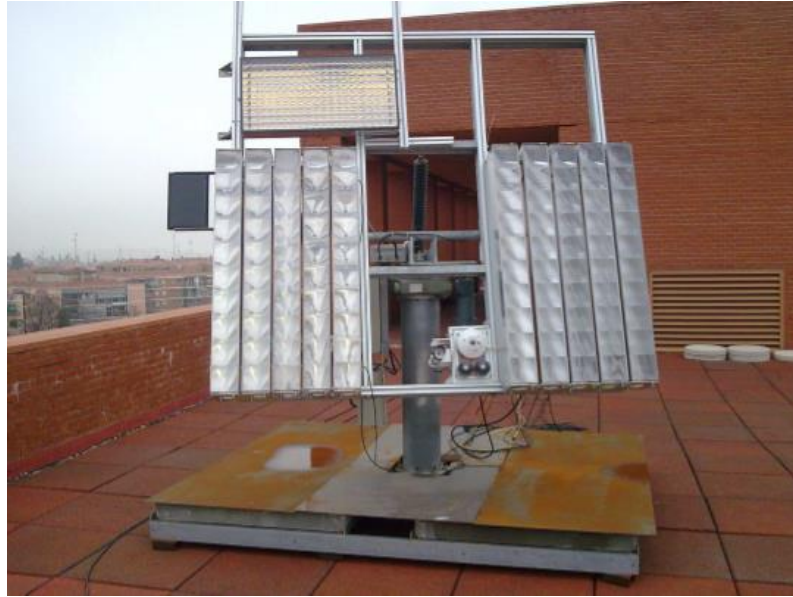
Figura 1.3 Panel fotovoltaico con concentrador solar (Fernández, 2009)
