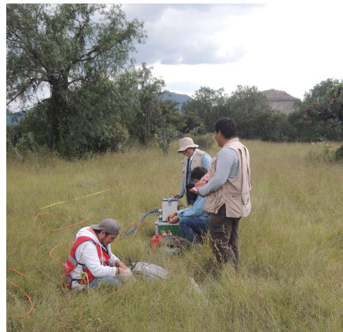
(b) Adquisición de datos de TRE con resistímetro Syscal Jr (IRIS Instruments, 2012)
