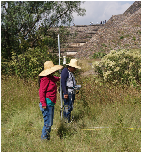
(a) Adquisición de datos magnéticos con Magnetómetro de Cesio G-858 Magmapper (Geometrics, 1996)
