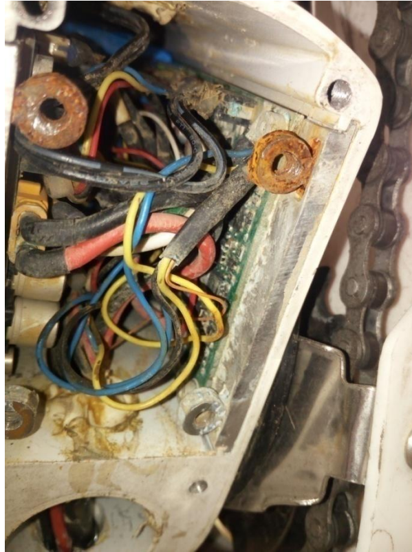
Figura 7.1. Daño en el sistema electrónico por filtración de agua.
