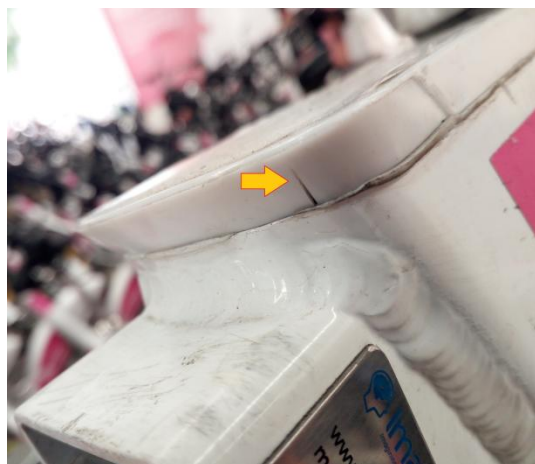
Figura 7.3. Fisura en tapa superior.
