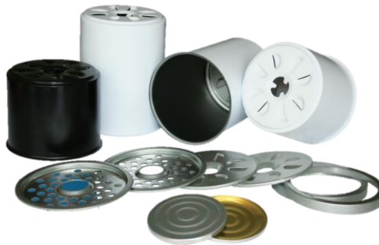
Figura 2.3 Piezas fabricadas por procesos de troquelado. [12]
