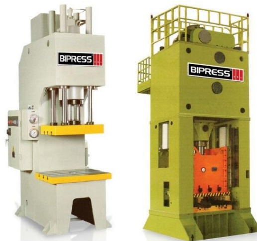
Figura 2.10 Lado izquierdo prensa hidráulica de escote. Lado derecho prensa hidráulica de lados rectos. [2]
