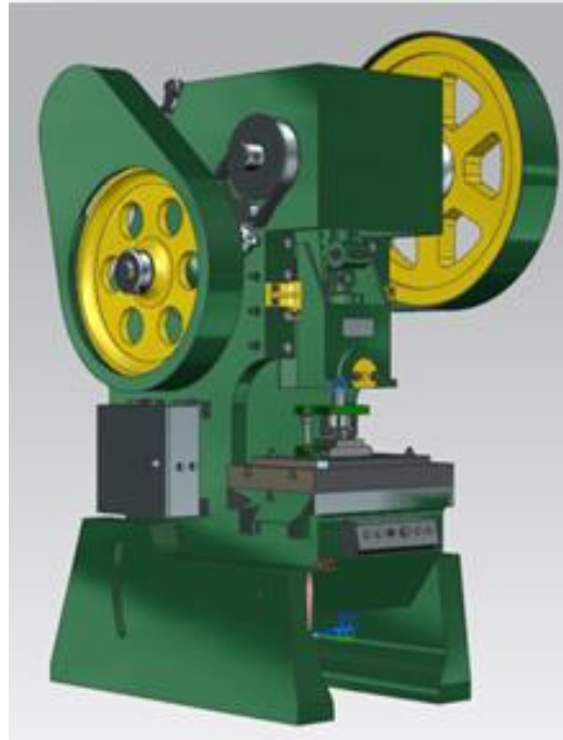
Figura 4. Troqueladora instalada en el edificio “O” de la facultad de Ingeniería
