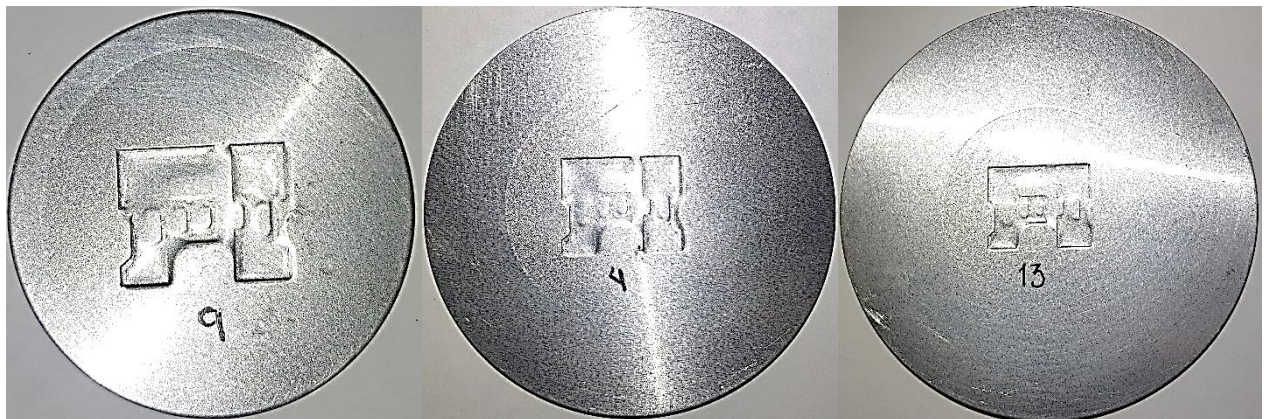
Figura 4.15 Resultados de discos estampados de 60, 85 y 100 mm de diámetro, posicionados respectivamente.
