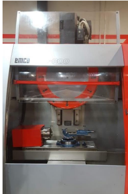
Figura 3.10 Centro de Maquinado Vertical VMC 300 instalado en el Laboratorio de Manufactura Avanzada de la Facultad de Ingeniería.
