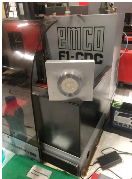
Figura 3.14 Prueba de ensamble con placa portamatriz y la matriz de estampado.
